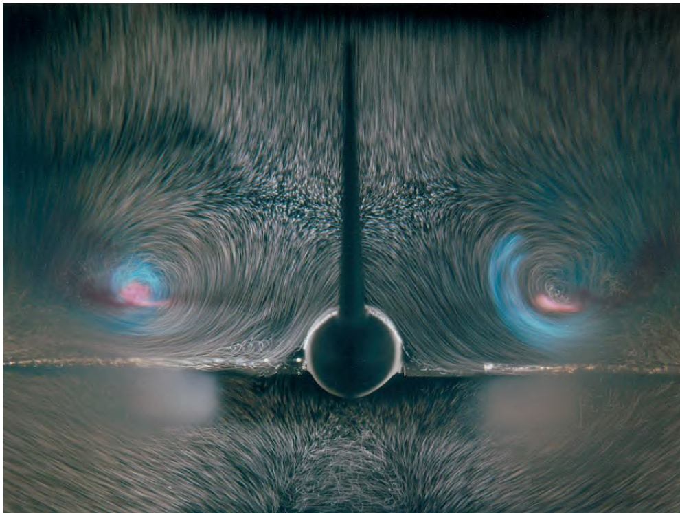
FIGURE 3.10 – Visualisation par plan laser des lignes de courant de l'écoulement transverse autour du Concorde.(image ONERA.)
