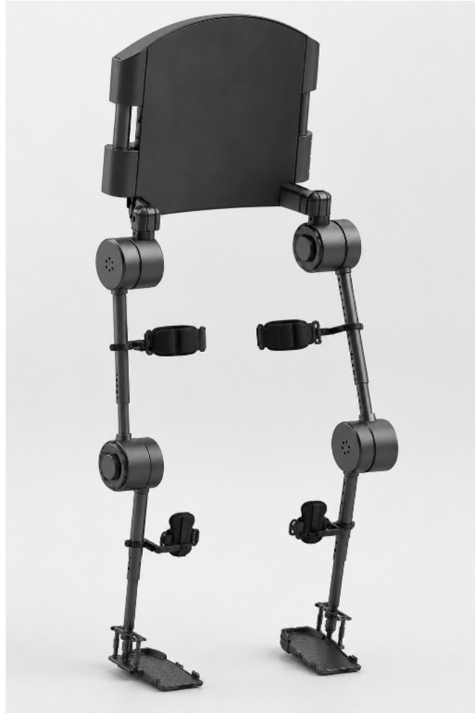
FIGURE 4 – Rendu CAO de l'exosquelette pédiatrique complet : coque dorsale de maintien (haut), actionneurs de hanche et de genou, segments cuisse/tibia en aluminium avec glissières télescopiques, supports de pied, et ressorts d'équilibre.
